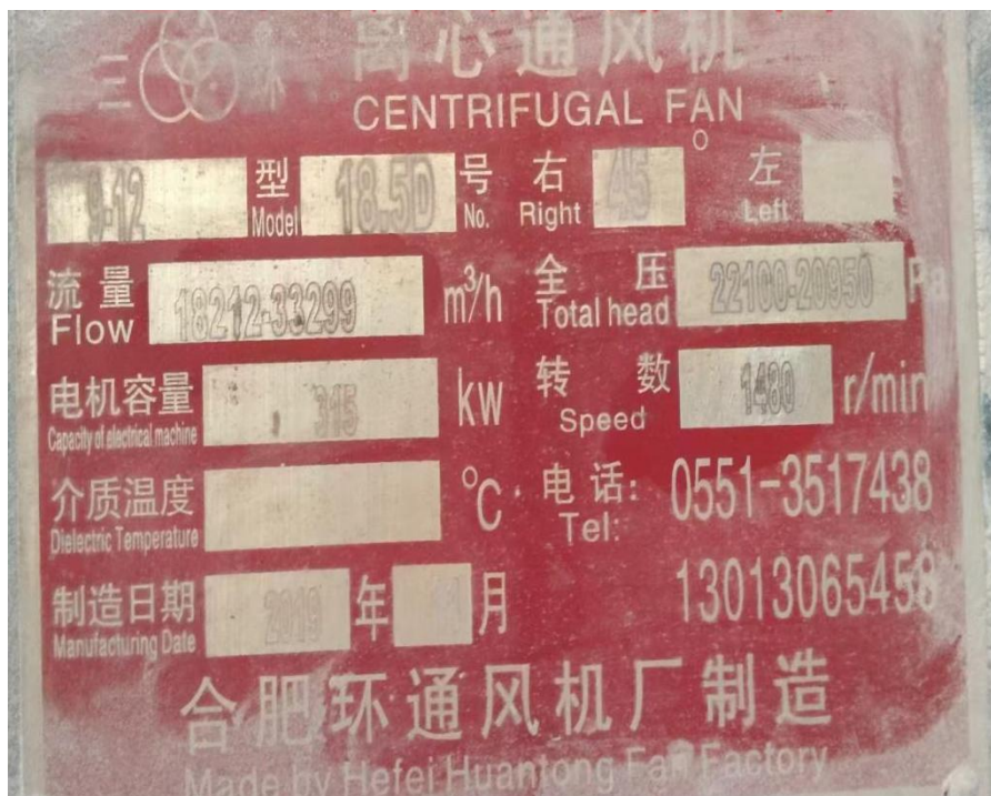
图8 1#2#钢立窑的鼓风机铭牌
